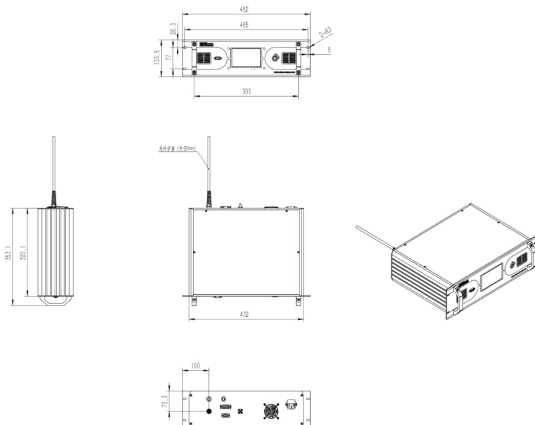
**FIGURE 2 系统外形图 System Outline Drawing**
