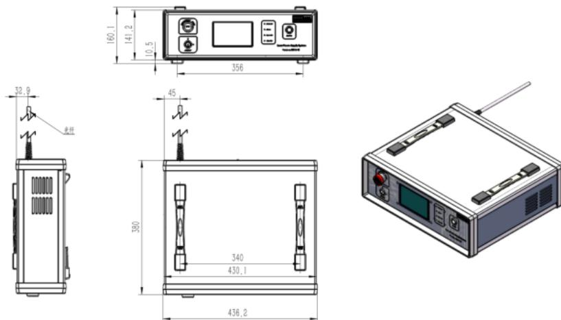
**FIGURE2 系统外形图 System Outline Drawing**
