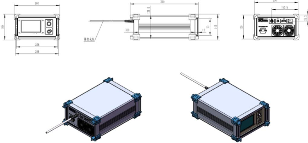
**FIGURE2 系统外形图 System Outline Drawing**
