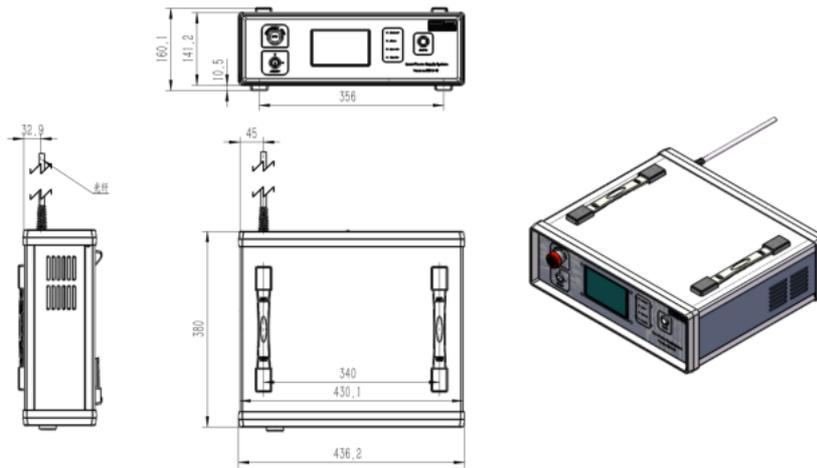
**FIGURE 2 系统外形图 System Outline Drawing**
