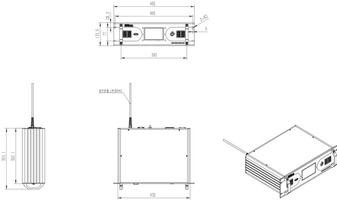
**FIGURE 2 系统外形图 System Outline Drawing**
