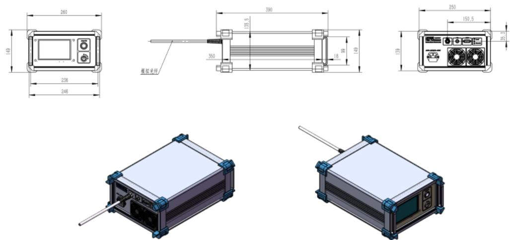
**FIGURE2 系统外形图 System Outline Drawing**
